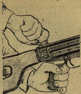
Фиг. 6. Следи се за направляващото / т ебло с възвратно-бойната пружина
